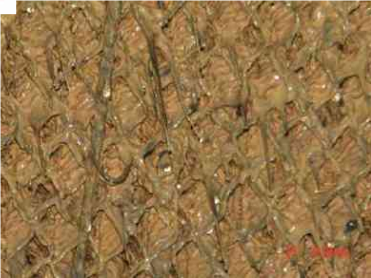
CT FILL FOULING
